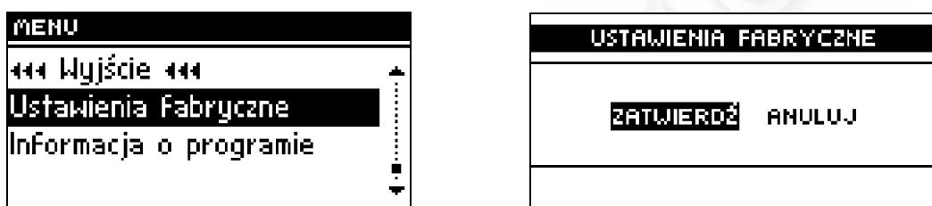
Регулятор предварительно настроен для работы. Однако, его следует привести в соответствие с собственными потребностями. В каждом моменте можно возвратиться к заводским настройкам. Включая функцию **заводские настройки**, теряются все настройки котла, установленные пользователем, а появляются настройки. Записанные производителем. С этого момента можно заново установить собственные параметры котла.
