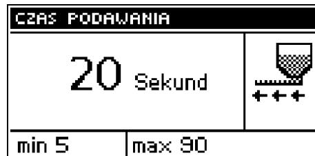
Эта функция служит для установки времени работы подавателя топлива. Время работы следует установить в зависимости от применяемого топлива, вида и мощности котла.
