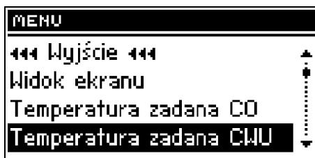
Этот режим служит для установки заданной температуры воды горячего водоснабжения. Пользователь может изменять диапазон температуры от 40°C до 75°C.
