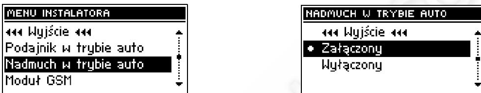
С помощью этой функции можно отключить или включить автоматическую работу вентилятора. Наддув можно отключить для ручной настройки естественной тяги дымохода.
