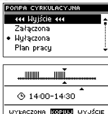
Эта функция служит для управления насосом, смещающим горячую воду между котлом и приемниками воды горячего снабжения. Пользователь при помощи этой функции настраивает суточный цикл активации или простоя насоса с точностью до 30 минут.
