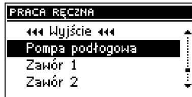
Нажатие **импульсатора** запускает двигатель выбранного устройства. Это устройство работает до повторного нажатия кнопки **импульсатора**.
