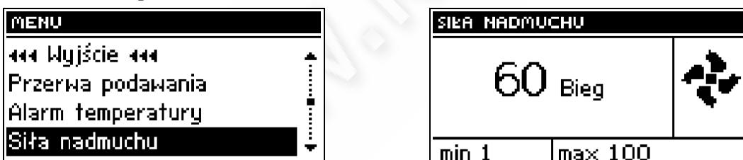
Эта функция управляет скоростью работы вентилятора. Область регулировки находится в пределах от 10 до 100%, (можно принять, что это скорости вентилятора). Чем выше скорость, тем быстрее работает вентилятор, где 10% - минимальная скорость вентилятора, а 100% - максимальная работа вентилятора.
