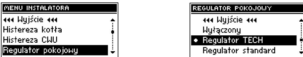
К регулятору **ST-48** можно подключить комнатный регулятор. После его включения контроллер настраивается через комнатный регулятор. Пользователь может выбрать вид комнатного регулятора:
