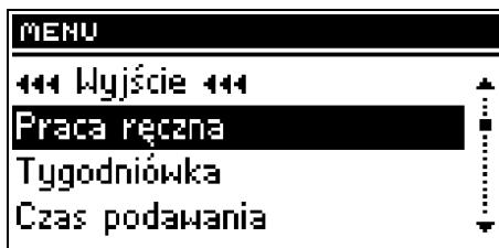
Для удобства пользователя регулятор оснащен модулем **ручной работы**. В этой функции каждое исполнительное устройство (подаватель, наддув, насос Ц.О., насос Г.В.С. циркуляционный насос, напольный насос, клапаны) включается и выключается независимо от остальных.
