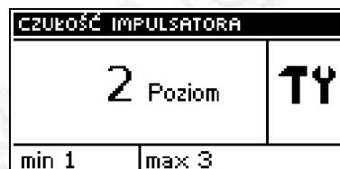
При помощи этой настройки можно изменить чувствительность ручки импульсатора в пределе от 1 до 3 (где 1 - наивысшая чувствительность).
