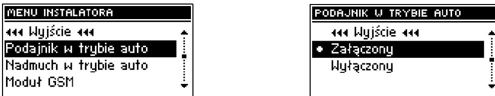
Это возможность включения или выключения автоматической работы подавателя. Подаватель можно выключить для ручной подачи топлива или для того, чтобы вызвать погашение котла.
