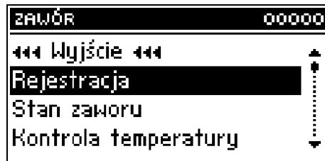
В этой функции установщик вписываетя серийный номер модуля, управляющего сервомотором трёхходового клапана (**ST-61**, это пятизначный номер, находящийся на корпусе этого модуля). Без этого номера функция не будет активна.
