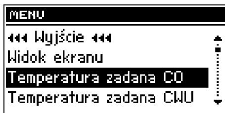
Этот режим служит для установки заданной температуры котла. Пользователь может изменять диапазон температуры на котле от 45°C до 80°C. Заданную темп. ц.о. можно также изменить непосредственно с главного экрана контроллера, поворачивая регулятор импульсатора.
