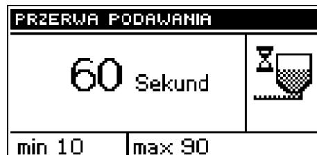
Время перерыва служит для установки перерыва в работе подавателя топлива, перерыв следует установить в зависимости от
