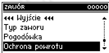
Эта функция позволяет настроить защиту котла от слишком холодной воды, возвращающейся из главной циркуляции, которая могла бы быть причиной низкотемпературной коррозии котла. Защита возврата действует таким образом, что когда температура слишком низкая, клапан прикрывается до времени, пока короткий цикл снова не достигнет соответствующей температуры. Эта функция защищает также котел от опасной высокой температуры возврата, чтобы вода не закипела.
